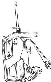
注意：VXD450U底面にある、ノイズキャンセリングマイク孔が塞がっていないことを確認してください。塞がっていると、ノイズキャンセルの効果を得られない場合があります。
