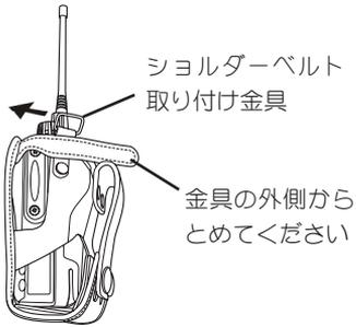
必要に応じて、キャリングケースの金具に、LCC-D450 に付属のショルダーベルトを取り付けます。
