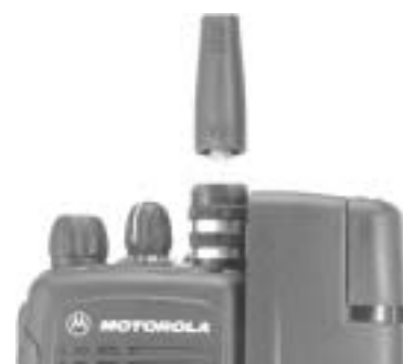
図4. RFスイッチ・アダプタの取付け
